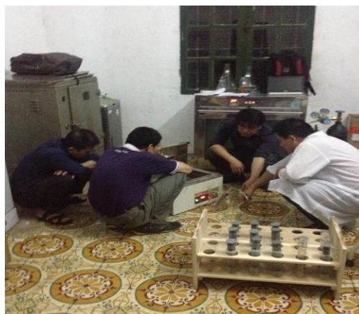
Ảnh 2: Chuẩn bị xylanh làm thí nghiệm in vitro gas production
